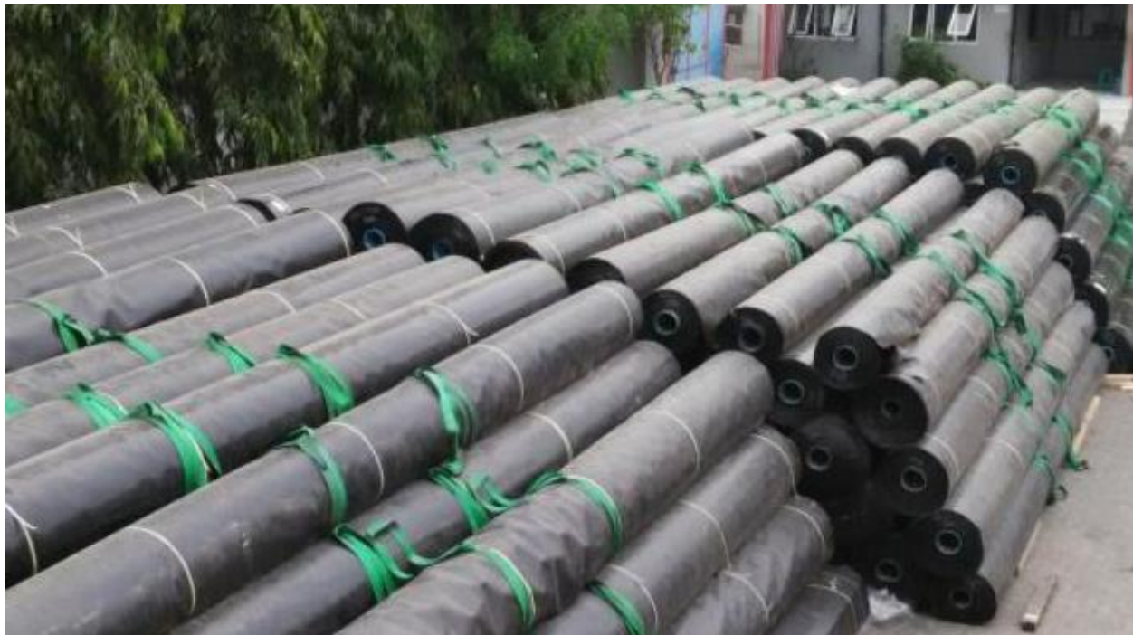
تصویر ۱: تسمه برزنتی جهت بارگیری و تخلیه رول های ژئوممبرین
