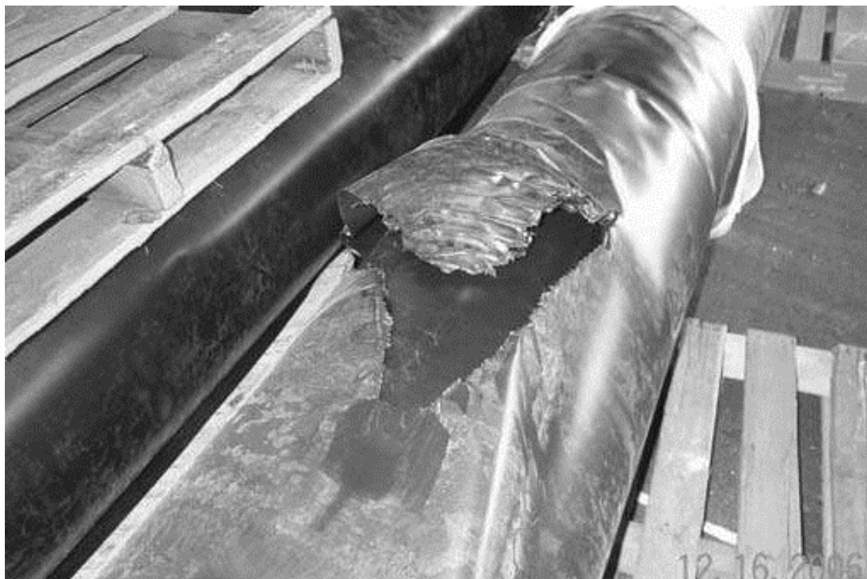
تصویر ۲: آسیب دیدگی ژئوممبرین به دلیل بی دقتی در بارگیری و یا تخلیه
